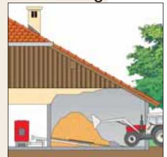
Almacén junto a la habitación de la caldera
