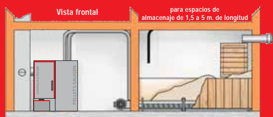
1. Sistema de pellets con descarga de espacios y sistema de aspiración RAS
